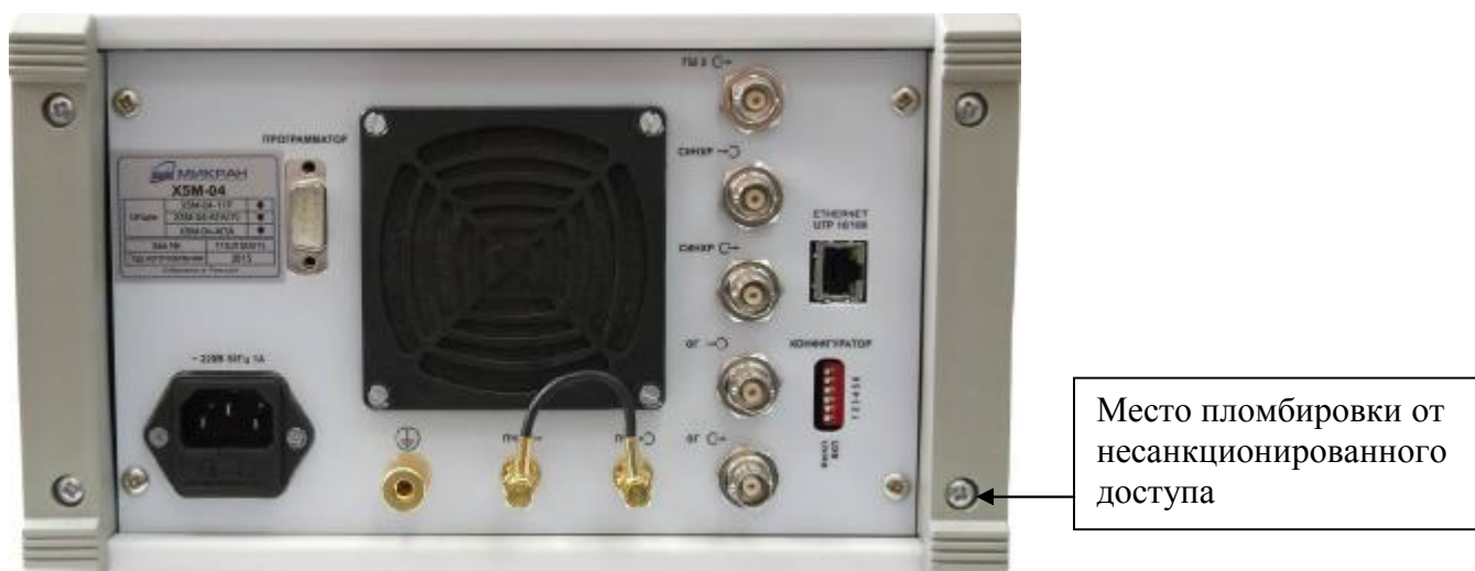
Рисунок 2 – Внешний вид измерителя X5M-04 (задняя панель)
