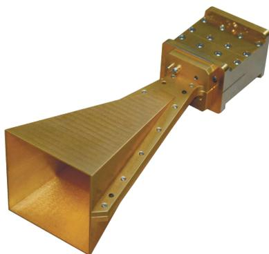
Двухканальная рупорная измерительная антенна П6-138 (П6-138М) представляет собой равносторонний пирамидальный рупор с присоединенным двухканальным поляризационным селектором линейной или круговой поляризации. Предназначена для приема и передачи сигналов линейной или круговой поляризации в диапазоне от 40 до 60 ГГц.
