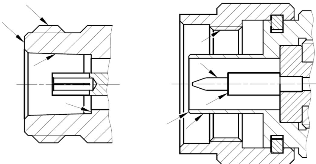
Рисунок 4.1 – Очищаемые поверхности
