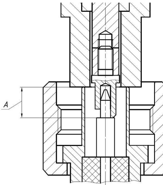
Рисунок 4.4 – Проверка размера «А» соединителя «вилка»
