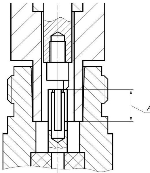
Рисунок 4.3 – Проверка размера «А» соединителя «розетка»
