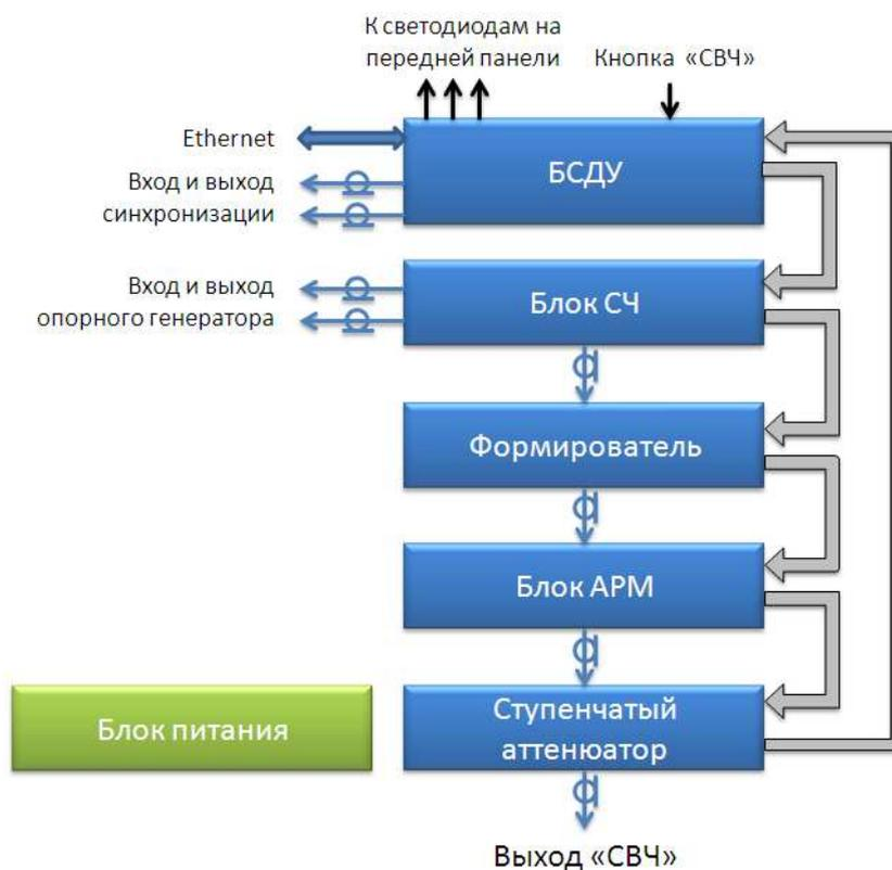
Рисунок 4.1 – Структурная схема Г7М
