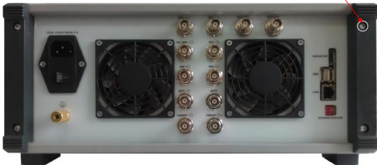
Рисунок 2 - Схема пломбировки от несанкционированного доступа
