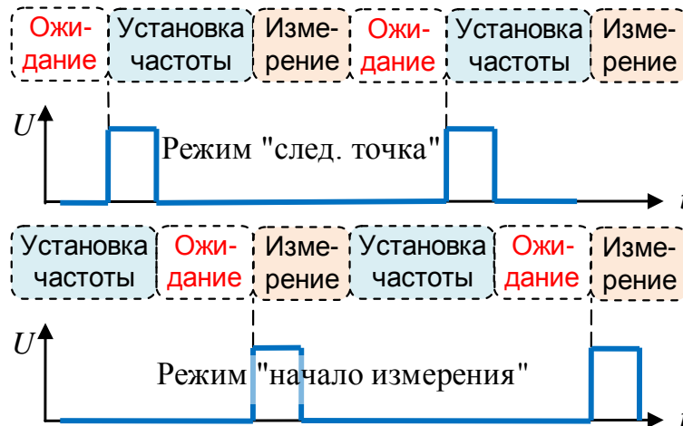
Рисунок 37 – Режимы работы входа синхронизации
