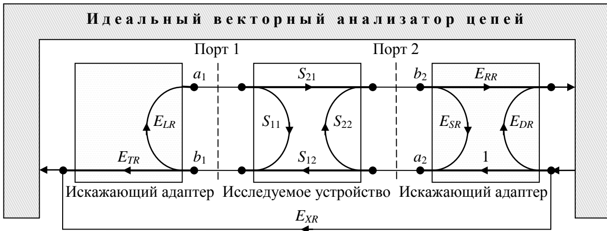
Рисунок А.3 – Модель с 6 факторами ошибок при обратном зондировании
