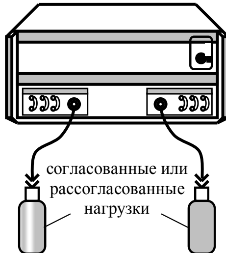
Рисунок 24 – Измерение изоляции между портами
