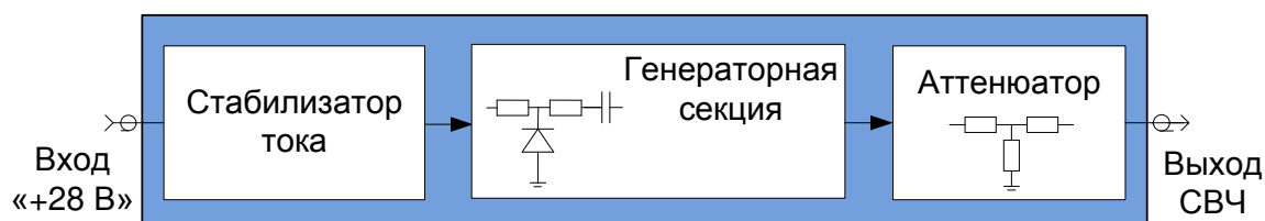
Рисунок 3 – Структурная схема ГШ
