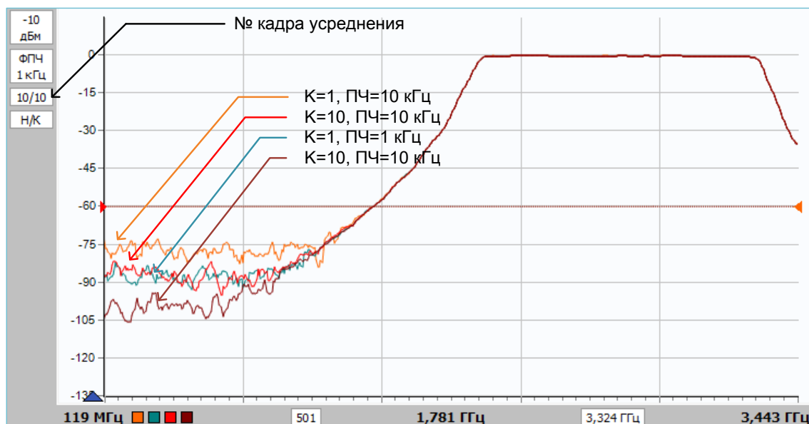
Рисунок 5.2 – Влияние усреднения и полосы пропускания фильтра ПЧ
