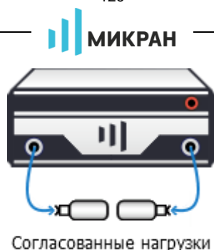
Рисунок 3.20 – Измерение изоляции между портами
