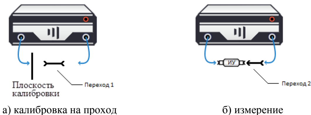
Рисунок 5.25 – Использование эквивалентных переходов
